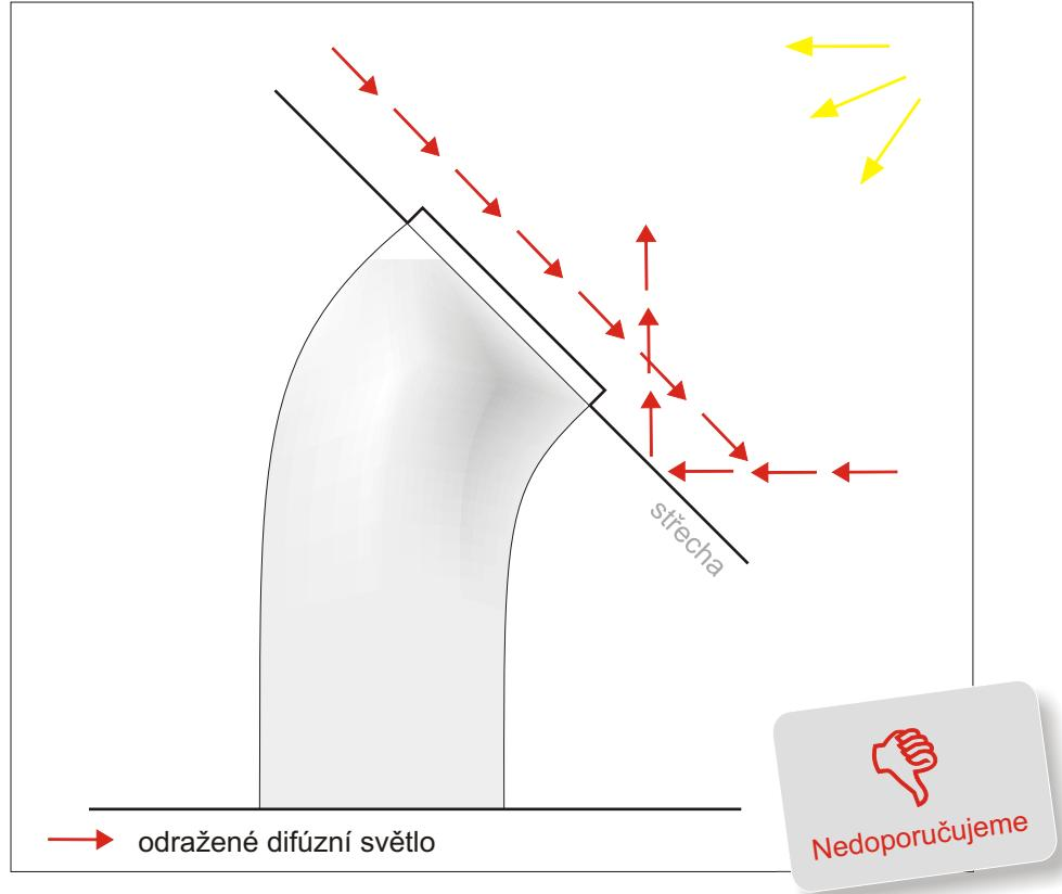
Střešní kopule světlovodu dokáže optimálně absorbovat jak přímé sluneční paprsky, tak i světlo odražené od střešního pláště či světlo dopadající šikmo na střechu.
