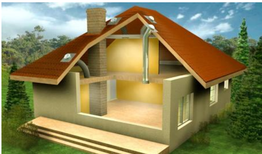
Řez světlovodem ALLUX určeným pro nízkoenergetické a pasivní domy
