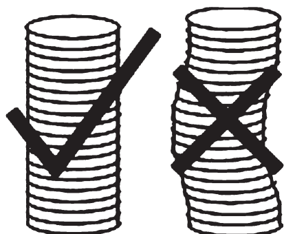
Obr. 12 Flexibilní tubus je nutné při montáži vypnout.
